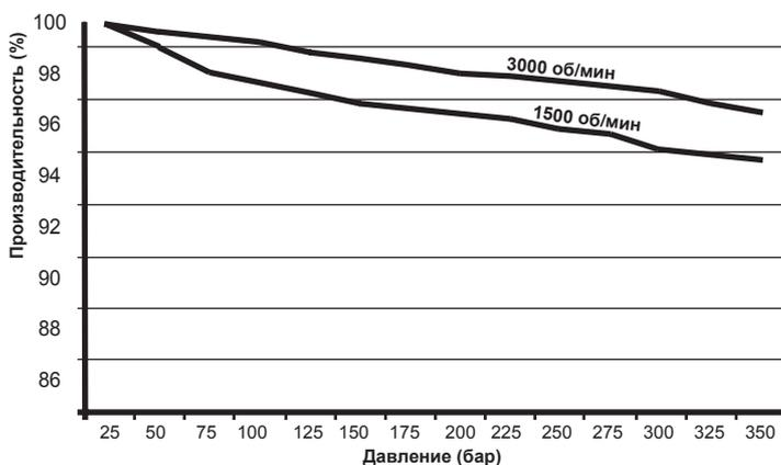
ПРИМЕЧАНИЕ: Это фактическая объемная производительность, измеренная на насосе 34 см<sup>3</sup>/об. Производительность насосов с другим рабочим объемом будет варьироваться выше или ниже этой кривой.
