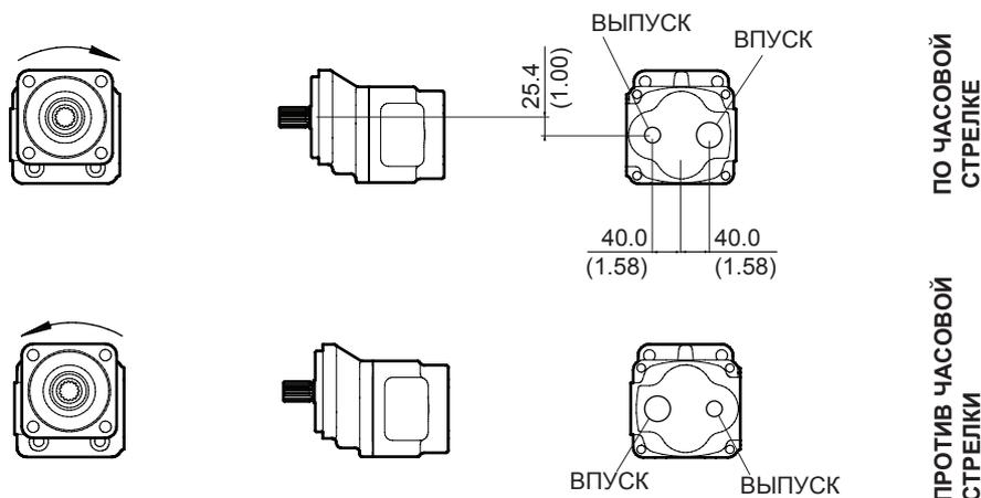
Задние порты доступны на Однoчных насосах и на задних секциях многосекционных насосов
