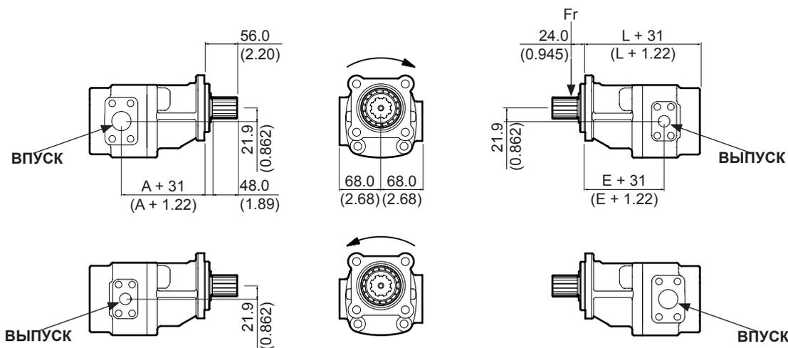
Макс. радиальная нагрузка (Fr) при 24.0 (0.945) from установочной плоскости = 9000N (2025 фунт-сил)
