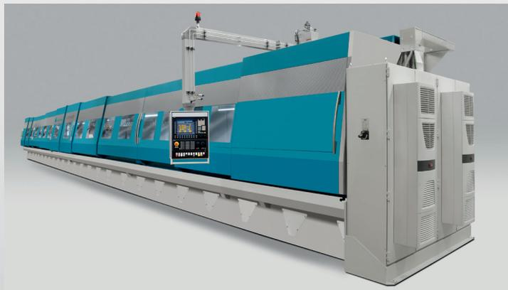
Станок глубокого сверления серии ML700 также оптимально предназначен для обработки гидроцилиндров с применением комбинированных инструментов для развертки и раскатки.
